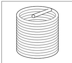
**特徴** リコイルネジ山修正キットの付属パケットの補充用セット。めねじを同サイズ、同ピッチで再生でき、耐久性も向上します。
