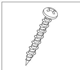
**特徴** 特殊なねじ山が高い引き抜き強度を発揮します。プラグなしでコンクリート、モルタル、ブロックなどにご使用できます。材質：鉄。表面処理：ラスパート。
