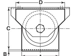
※使用されるレール幅の2/3以上車輪幅(h)がくるように使用してください。
