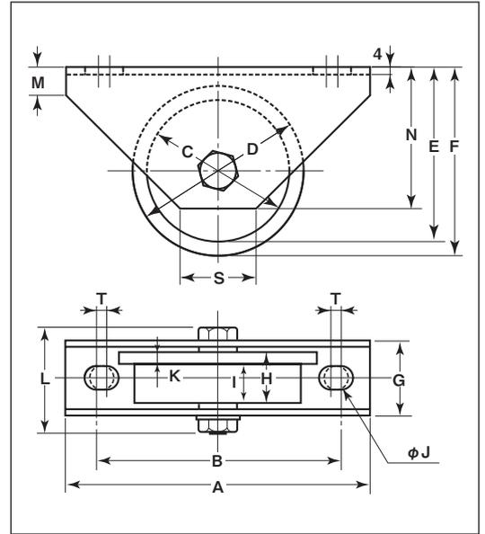
※枠、軸の材質はSUS304、車の材質はSUS303です。
