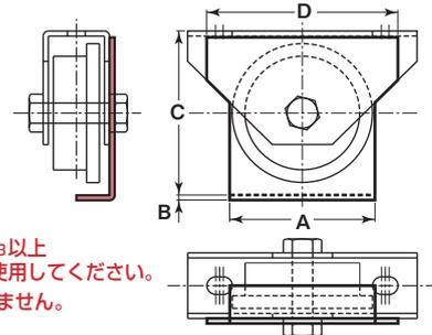
※使用されるレール幅の $\frac{2}{3}$ 以上車輪幅(h)がくるように使用してください。
