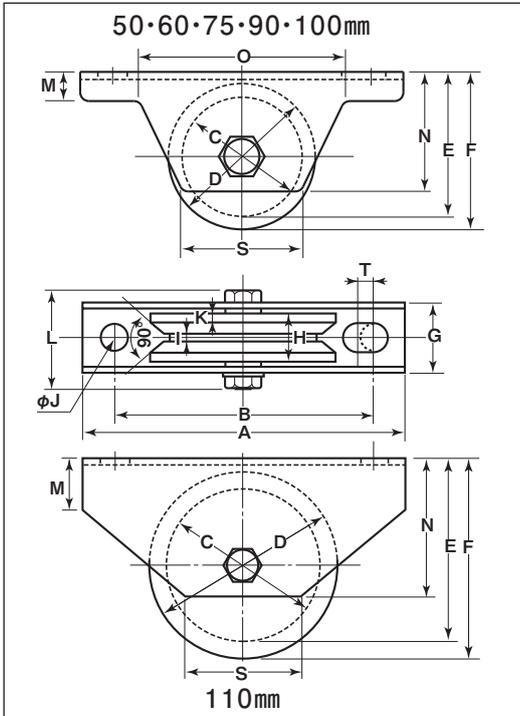
※枠、軸の材質はSUS304、車の材質はSUS303です。
