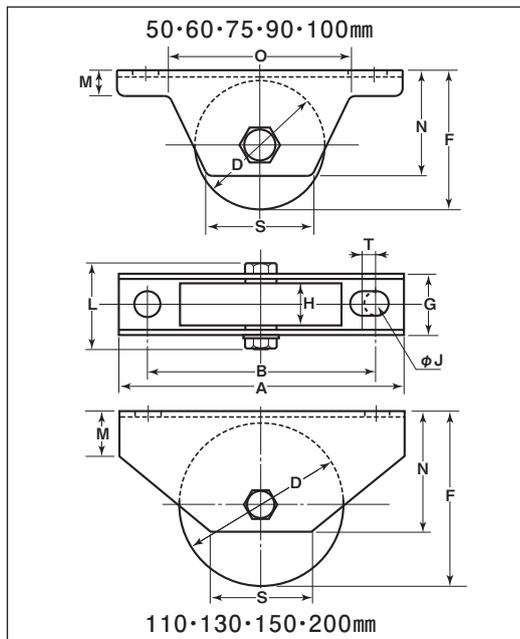
※枠、軸の材質はSUS304、車の材質はSUS303です。
