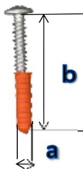
WF ビス／材質:SUS410 プラグ／材質:ナイロン コンクリート用 ビス・プラグ系
