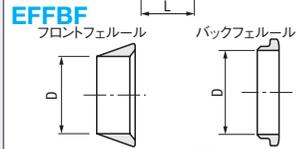
\*フロントフェルールとバックフェルールはセットで使用してください。 ■材質 SUS304
