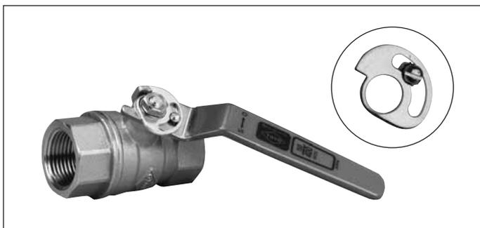
メモリーストップ板をレバーハンドルに取付け、前もって任意の開度に調整しておけば、いつもボールバルブを同じ開度位置に保てます。ご使用になる際、特に高速流体配管における中間開度位置での長期間放置は著しくシートの封止性能を低下させ、シート漏れを生ずることがありますのでご注意ください。このメモリーストップ板は、下記の機種のみ50<sup>A</sup>までオプション仕様として取付けられます。
