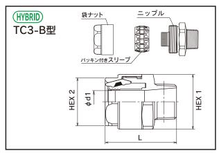
※ 材質 TC3-B: ニップル、袋ナット ( 真鍮\* )、ゴムパッキン ( NBR )、 スリーブ (ポリアセタール)
