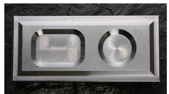
ランピング加工 Ramp cutting
