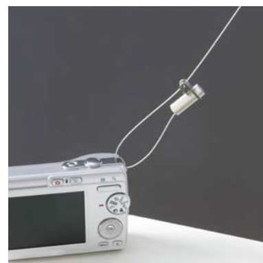
ワイヤーロックタイプ (S-324) ワイヤーロープを展示品に通し、金具先端に差し込むだけでロックされ、作業時間が短縮。解除キーによりロックがはずれ繰り返し使用できます。
