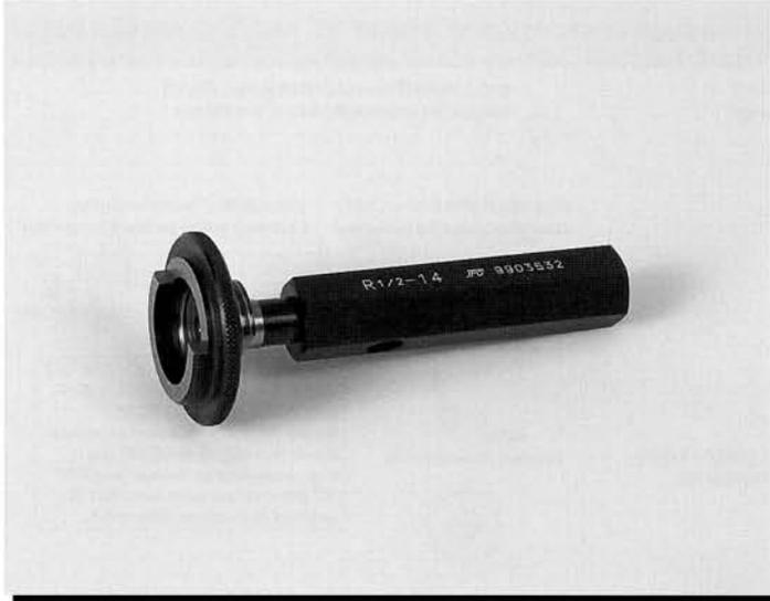
ISOゲージ規格の導入により新しくJISに制定されたもので耐密性を必要とする結合を主目的とするねじ (R, Rc及びRp) の検査に使用するテーパねじゲージです。RとPTの製品ねじは全く同一寸法ですが、ゲージ方式が異なります。管又は管継手の末端が、ゲージの切欠きの長さの範囲内にあれば合格です。従来の管用テーパねじゲージPTとの相違点は、次の通りです。
