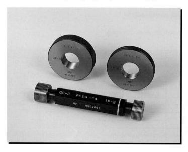
管、管用部品、流体機器等の接続に用いる耐密性を必要 としない機械的結合を主目的としたねじ (PF) の検査に使 用するゲージです。
