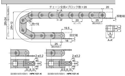
※.取付金具HPK101-Kは、固定端と移動端がセットになっています
