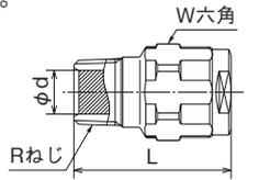
▨部に管端防食継手のコアが接続されます。
