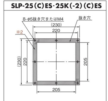
※2 塗装や表面保護膜などにより、取付面が絶縁されている場合は、※2の斜線部分の剥離を行い導電面を確保してください。
