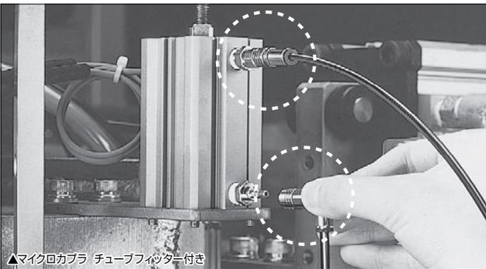
ソケット SCB型 (チューブフィッター付き パネル取り付け用)
