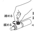
調整ネジ(上) 調整ネジナット(下)
