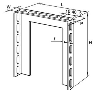
■切断、溶接、穴開け不要の門型パイプサポート架台です。
