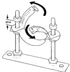
②パイプをのせ、組式合せバンドを組付け、あとはナットを締めるだけ。ストッパー付なので、ナットを締めつければ合せバンドははずれません。
