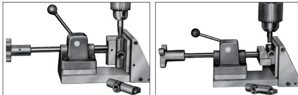
上の写真はQCL9PAを使い継手穴あけタッピングの専用パイプを作り能率倍増した例
