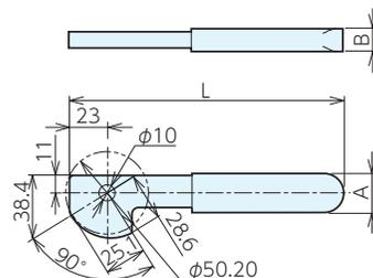
CAM LEVERS FOR CENTER CLAMPING &lt;TYPE A&gt;
