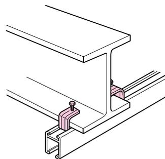
インテリアダクトの下溝に吊り金具をはめ込み、形鋼をさみボルト締めします。
