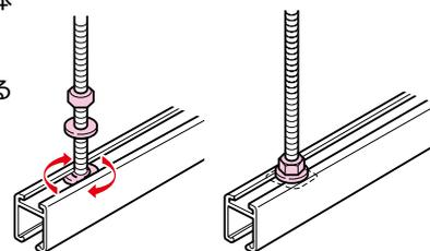
ボルトに吊り具を取り付け、インテリアダクトの下溝にはめ、吊り具を90°廻しナットで固定します。
