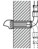
②壁外に出たネジを15mmほど残し、金ノコ等で切断してパッキン・カバーをはめ込み、カバー内のロックナットで締め付け固定します。
