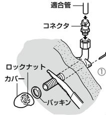
①壁に穴をあけ引込みエルボを壁内より差し込み、フランジ部を釘・木ネジ等で固定しコネクタを用い配管します。
