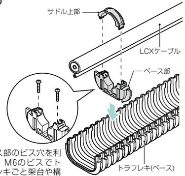
※ベース部のビス穴を利用し、M6のビスでトラフレキごと架台や構造物に固定できます。
