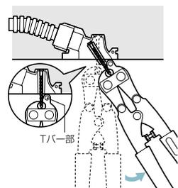
釘を挟み、先端のTバー部を支点に、「てこ」の要領で釘を引き抜きます。
