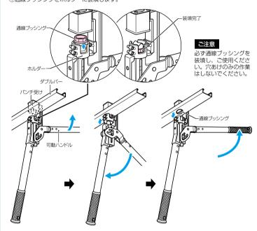
②可動ハンドルを全開 させた状態でダブル バー上部にパンチ受 けをはめ込みます。 ③可動ハンドルをゆっ くり閉じ、穴あけ、 通線ブッシング圧入 をします。 ④可動ハンドルを全開にし、 パンチ部を全開状態でダブ ルバーから取り外します。
