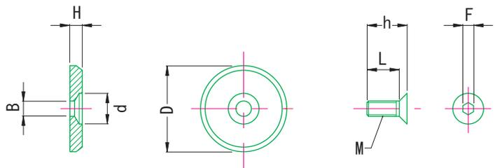
**材表** 本体 body : 鋼材SUM22L・黒色四三酸化鉄皮膜 Steel Black oxide finish
