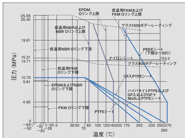
1. 図では、JIS B2220のSCPH2とASME B16.34のWC B、A105を適用した各クラスのボデーレーティングを参考のため示しています。
