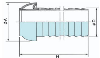
材質：SS (ダクロダイズド処理), SUS304
