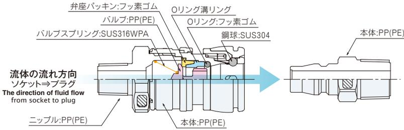
締め込みの際のトルク値 ネジ山をつぶさないように、必ず適正トルクでお取り付け下さい。
