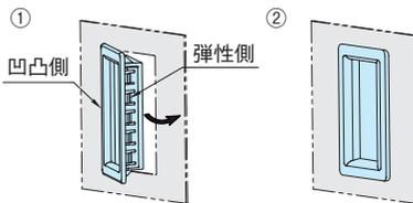
1. プルハンドルの凹凸側をパネルにはめ込み、弾性側を押し込みます。
