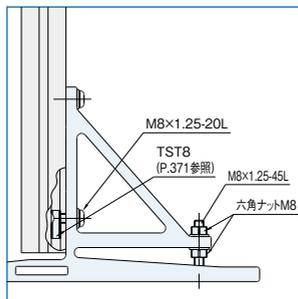
プロファイル底面に六角ボルト(M8×60L)を使用した例。
