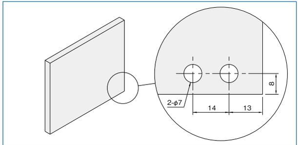
Line8プロファイルの溝でスライドドアとしてご使用いただけます。 パネルの仕様、及び加工。
