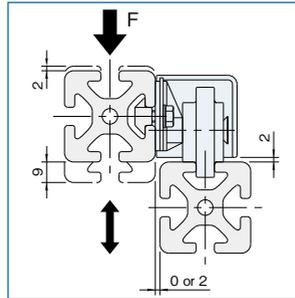
ローラの向きを変える事でプロファイル間の隙間を変更できます。
