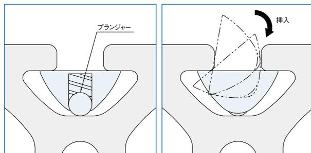
T溝に挿入されるとスプリングプランジャーのバネ圧でナットが仮止されます。垂直のフレームで使用する場合などに便利です。
