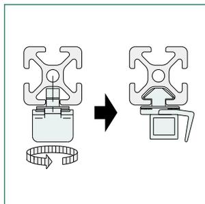
角ナット(板バネ支持)をスライドさせ、締付位置が微調整できます。
