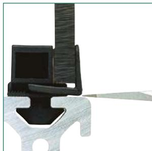
パネルやボードを穴加工やネジ締めなしでプロファイルに取付できます。スライド部のロックはスクリュードライバーで緩みます。
