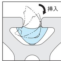
T溝に挿入されるとスプリングブランジャーのパネ圧でナットが仮止めされます。垂直のプロファイルで使用する場合などに便利です。
