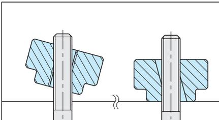
通し穴にボルトを挿入し、締め付け位置までスライドさせた後、ボルトに対して垂直な状態で締め付けてください。
