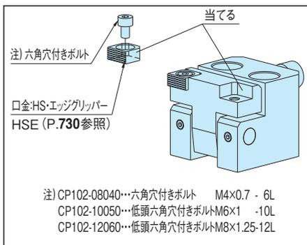
口金は交換可能です。交換は六角穴付きボルトを取外して行ってください。取付けの際は、口金の背面をアームに当て組み付けてください。
