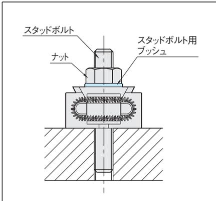
プレートのネジ穴にスタッドボルトを固定後、OKバイス、スタッドボルト用ブッシュ、ナットの順にセットします。次に、スパナ等でナットを回して、クランプ/アンクランプの操作を行います。
