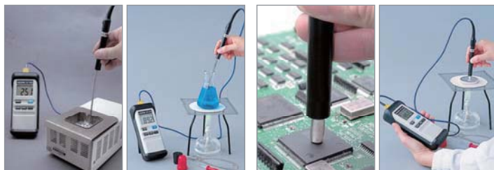
DT-510+DT-510A 使用例 (ハンダ槽温度、液体温度)
