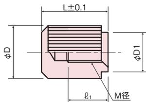
※ミクロブラック (ニッケル下地) 製品:メネジ部はニッケルメッキのみ (但しメネジ内部にミクロブラックが一部付着します)
