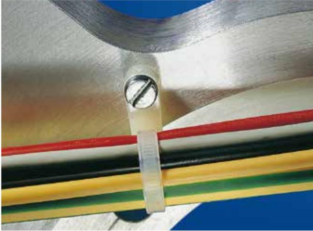
MSタイのスタンダードタイをベースに、ビス止め用固定穴を設けた一体成形のタイです。ビスでヘッドをパネルに固定することで、垂直な箇所でも確実に配線を結束・固定できます。
