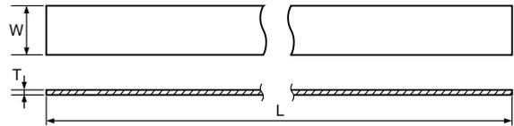
柔軟な面ファスナー式のグリップタイは、取り付け、取り外しの結束力調整が容易で、再利用できる経済的な結束バンドです。用途に合わせて必要な長さだけカットして使えるため、無駄が出ません。各色取り揃えているため、配線の識別にも便利です。
