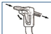
結束後もレバーを押すことでロックを解除できるため、繰り返し使用ができ経済的です。施工後、ケーブルを取り外して、再結束したい場合にご利用いただけます。11ナイロン製で、耐候性・耐塩害性・耐薬品性に優れています。※リピータイのページ(P61)にも掲載されています。
