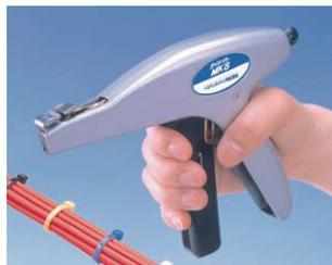
小型で、軽量、手に馴染みやすいデザインです。軽くトリガーを引くだけで、結束バンドの締め付けと切断が行えます。また、切断時の衝撃が少ないため、長時間作業にも疲れを残しません。締め付け強度の調整が簡単にでき、しかも調整用のつまみはトリガーカバーの中でガードされているため、常に安定した結束が可能です。
