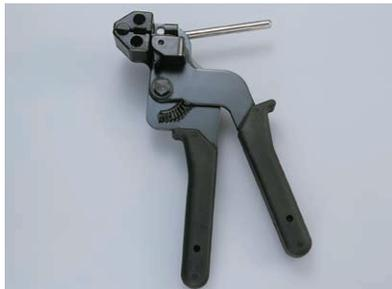
メタルタイの引き締めと切断を行う工具です。引き締め調整は、トリガーを引きながら行い、最後にタイカット用レバーを押し上げて、余分なタイを切断します。
