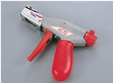
メタルタイ専用の工具です。小型、軽量で、簡単にメタルタイの締め付けと切断が行えます。締め付け強度が調整機能付きのため、適切な締め付け力を設定することが可能です。
