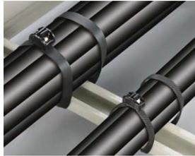
エンドレスタイの材料に用いている耐候性ポリアセタールは、弊社の試験で20年の屋外暴露後も強力な性質を保持することが実証されています。また吸水性がほとんどなく、湿度による影響も受けません。銅合金爪をロック機構に用いているため、ガッチリ結束します。ストラップはリール状のため、結束径を問わず、大口の結束が可能です。
